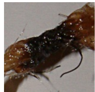
BT-V1 Wicklung demontiert nach 27.6 ml
