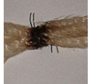
Patriot Mega Wicklung demontiert nach 27 ml
