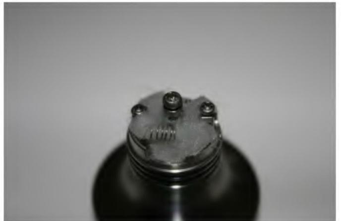
Die Verdampferkammer wird dann einfach auf die Base gesteckt. Sie hält aufgrund der gut gewählten O-Ringe sehr gut, ohne zu fest zu sitzen. Es wackelt nichts, die AFC lässt sich mühelos, aber nicht versehentlich verstellen und man benötigt keine Rohrzange, um die Kammer wieder abzuführen.
